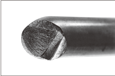
③ 冲击造成的弯曲破坏 销子受到冲击后发生弯曲破坏的情形。在有 起点那端承受拉伸负荷，破坏从起点处开始 发展。特别是当销子的表面有腐蚀时，销子 更容易发生弯曲，更容易引起此类现象。
