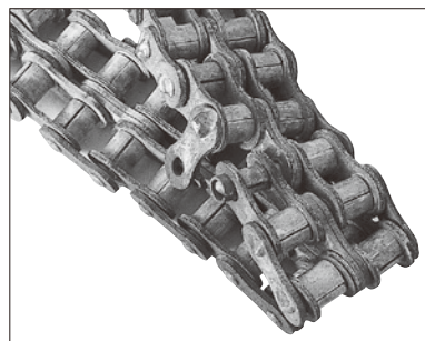
图34. 不锈钢滚子链的腐蚀
