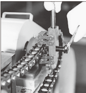
图5. 使用链条分解器的断开方法
