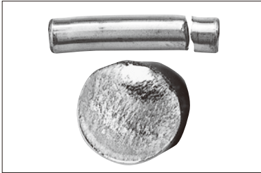
① 静态破坏 滚子链在进行抗拉强度试验时断裂的情形 在使用中的滚子链上，作用抗拉强度以上的 负荷时会引发该现象。
